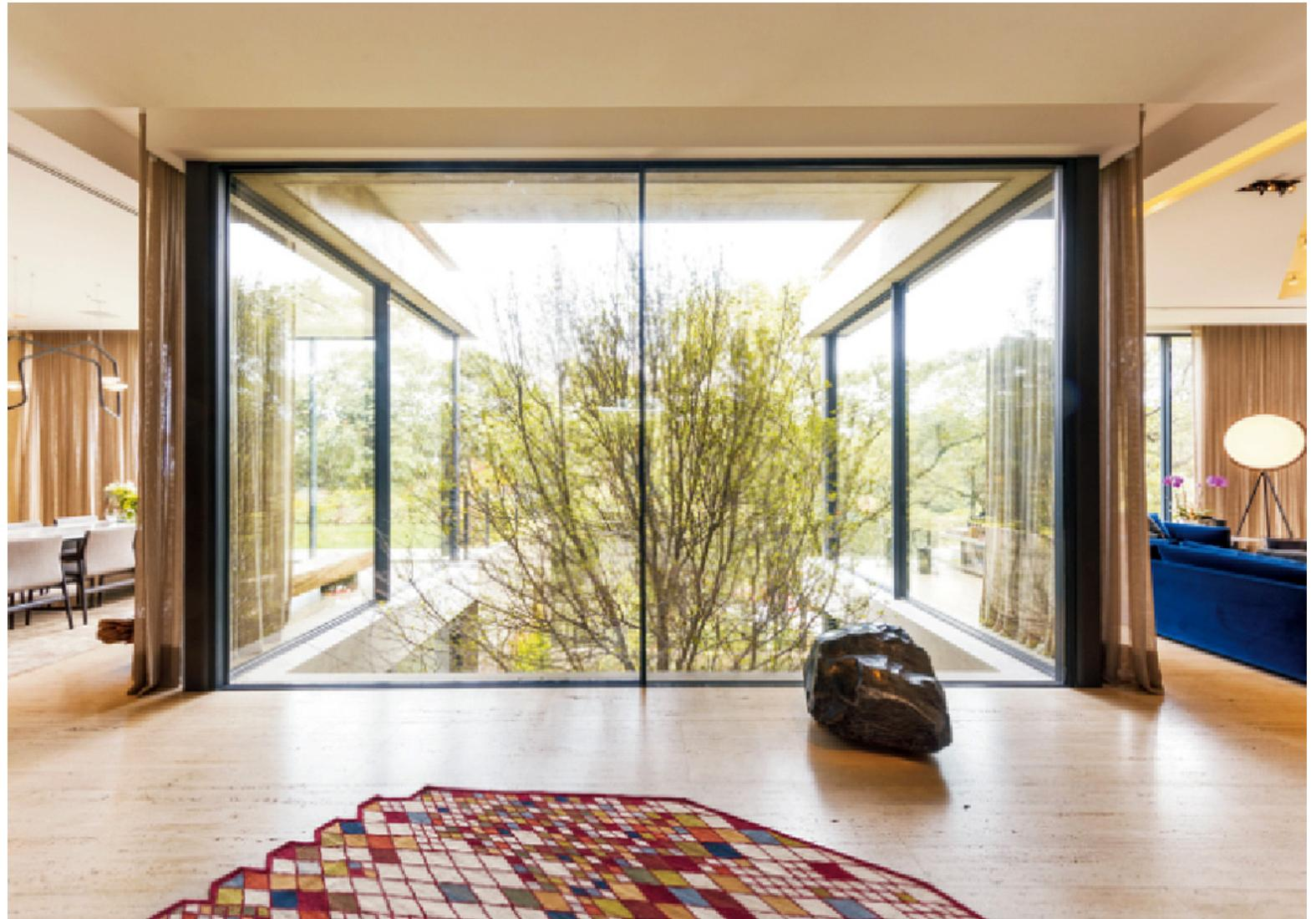
Ventanas de aluminio color negro mate ANODIZADO, CORTIZO COR VISION para ventanas correderas y CORTIZO COR 70 para ventanas abatibles, con rotura de puente térmico Vidrio laminar (4+4/14/Guardian sun 4+4) y altura hasta techos. Aislamiento Acristalamiento realizado mediante vidrios dotados de cámara con gas argón, bajo emisivos.
